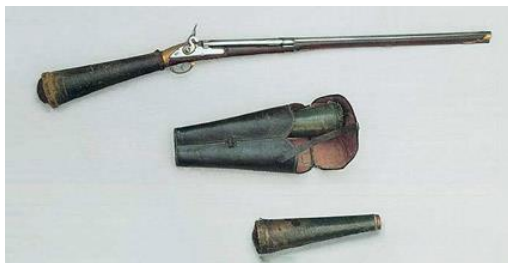
Винтовка Жирардони и сумка с баллонами к ней.
